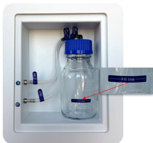
Εικόνα 21.1 Σύνδεση καλωδίων στη φιάλη ύγρανση και τον σταθμό εργασίας πολλαπλών ζωνών ART
