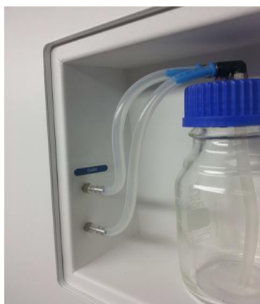
Εικόνα 11.5 Σωλήνες συνδεδεμένοι στη φιάλη
